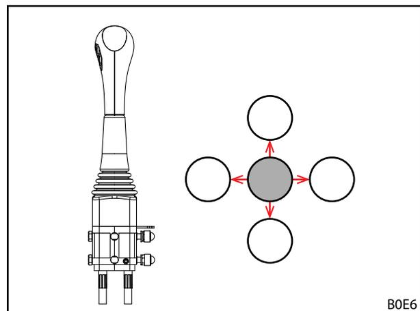
Abb. 54 Bedienhebel in alle Endlagen bewegen
