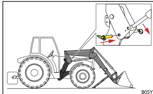
Abb. 48 Verriegelungsbolzen einstecken und mit Klappstecker sichern
