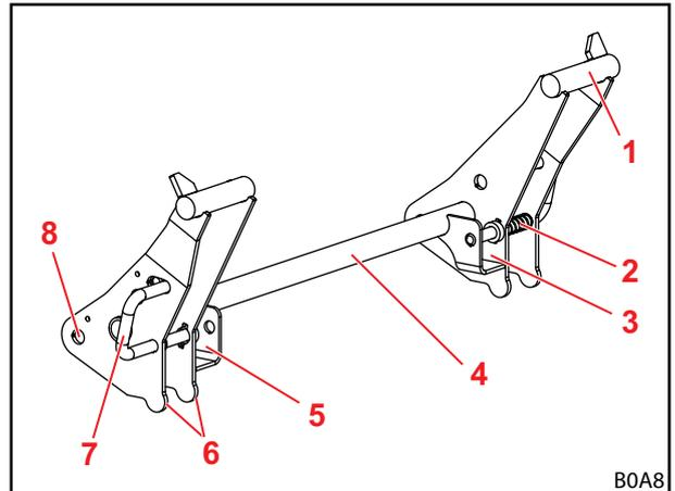
Abb. 25 Euro-Wechselrahmen
