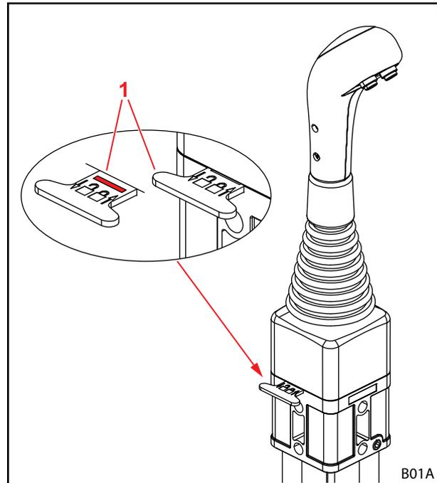
Abb. 53 Verriegelung des Bedienhebels
