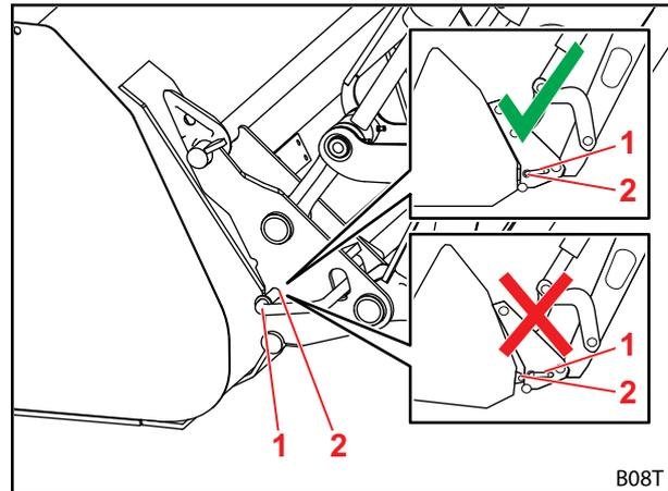
Abb. 73 Position der Verriegelungsbolzen prüfen
