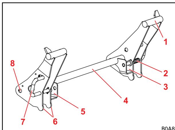
Abb. 15 Euro-Wechselrahmen
