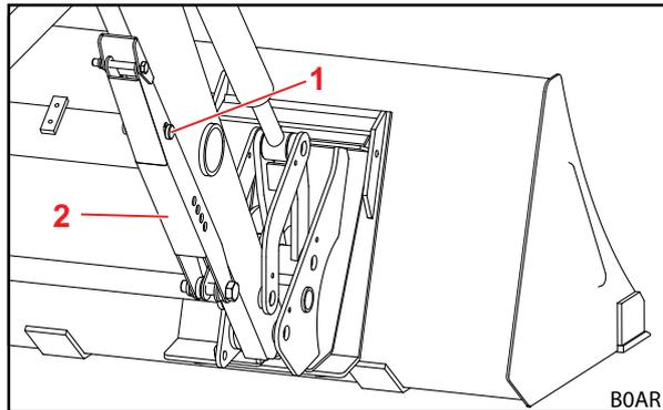
Abb. 59 Abstellstütze eingeklappt
