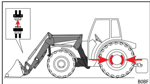
Abb. 92 Hydraulikleitungen lösen
