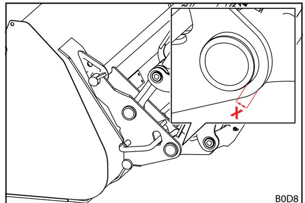
Abb. 109 Verschleißmaß des Wechselrahmens
