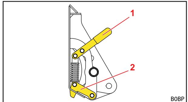
Abb. 67 Mechanische Werkzeug-Verriegelung Skid-Steer (halb geschlossener Zustand)
