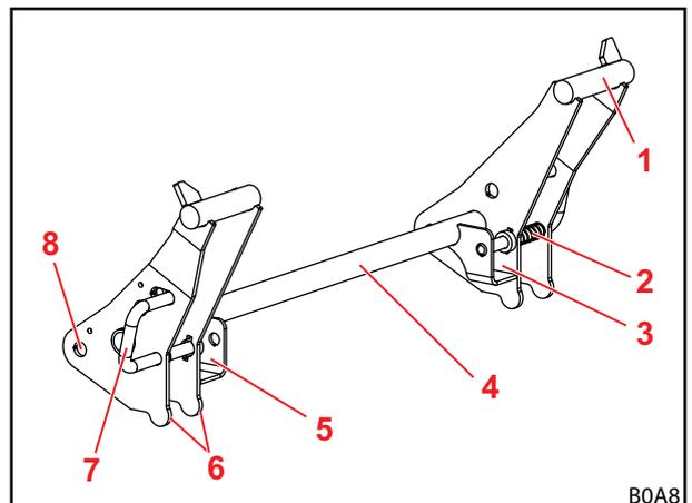
Abb. 72 Werkzeug-Verriegelung am Euro-Wechselrahmen
