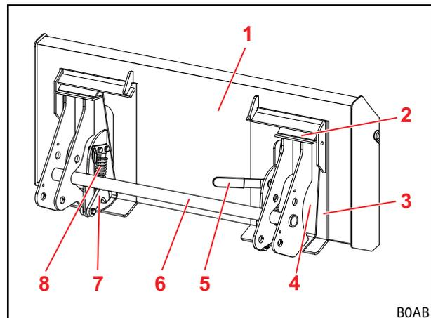
Abb. 23 Geöffnete Verriegelung
