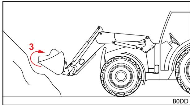
Abb. 102 Werkzeug nach hinten kippen und Ladegut aufnehmen
