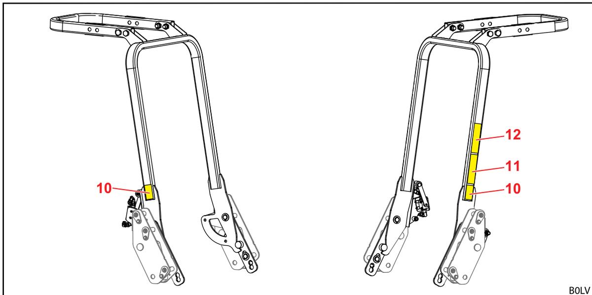
Abb. 6 OPG für Traktoren mit hinten angebrachter 2-Pfosten-Umsturzschutzvorrichtung (beispielhafte Abbildung)
