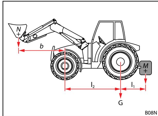
Abb. 43 Berechnung der statischen Standfestigkeit
