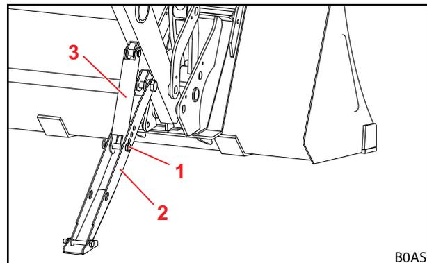
Abb. 60 Abstellstütze ausgeklappt
