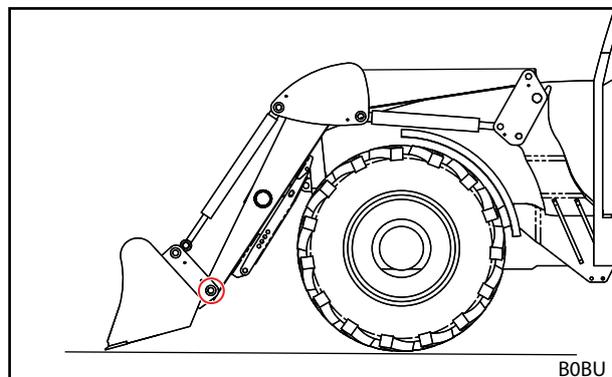
Abb. 87 Werkzeug in den unteren Bolzenlöchern verbinden
