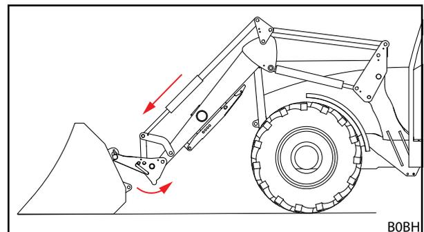
Abb. 93 Wechselrahmen aushaken
