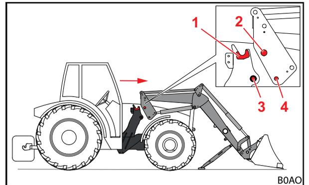
Abb. 45 Traktor in Schwinge einfahren
