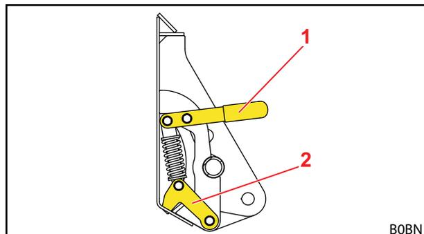
Abb. 66 Mechanische Werkzeug-Verriegelung Skid-Steer (geöffneter Zustand)
