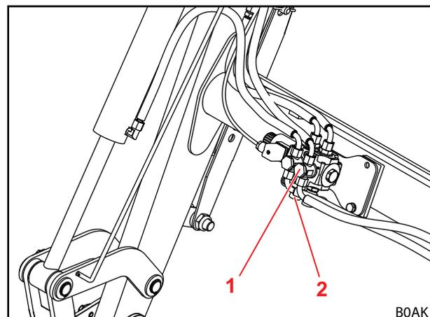
Abb. 37 Zusätzlicher 3. Steuerkreis
