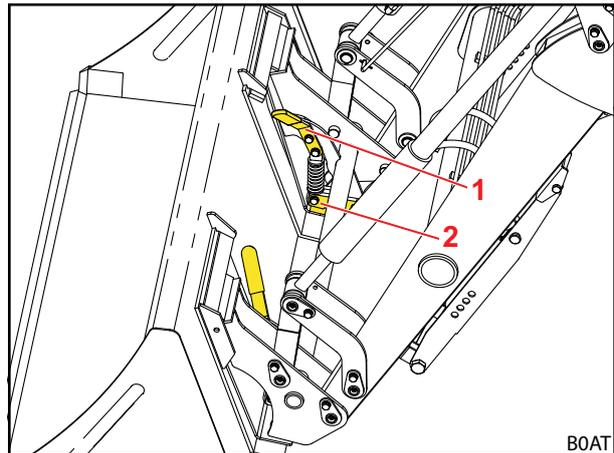
Abb. 75 Werkzeug-Verriegelung öffnen
