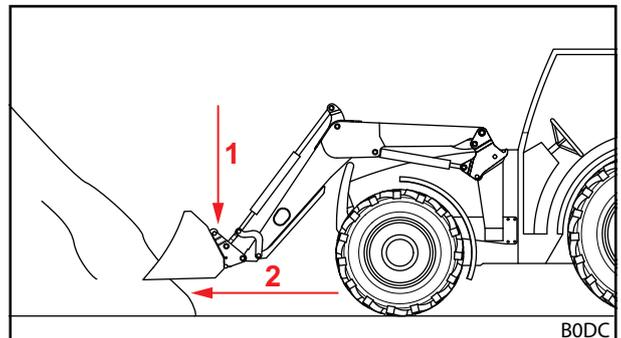
Abb. 101 Frontlader absenken und gerade in Ladegut einfahren
