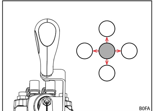
Abb. 58 Bedienhebel in alle Endlagen bewegen
