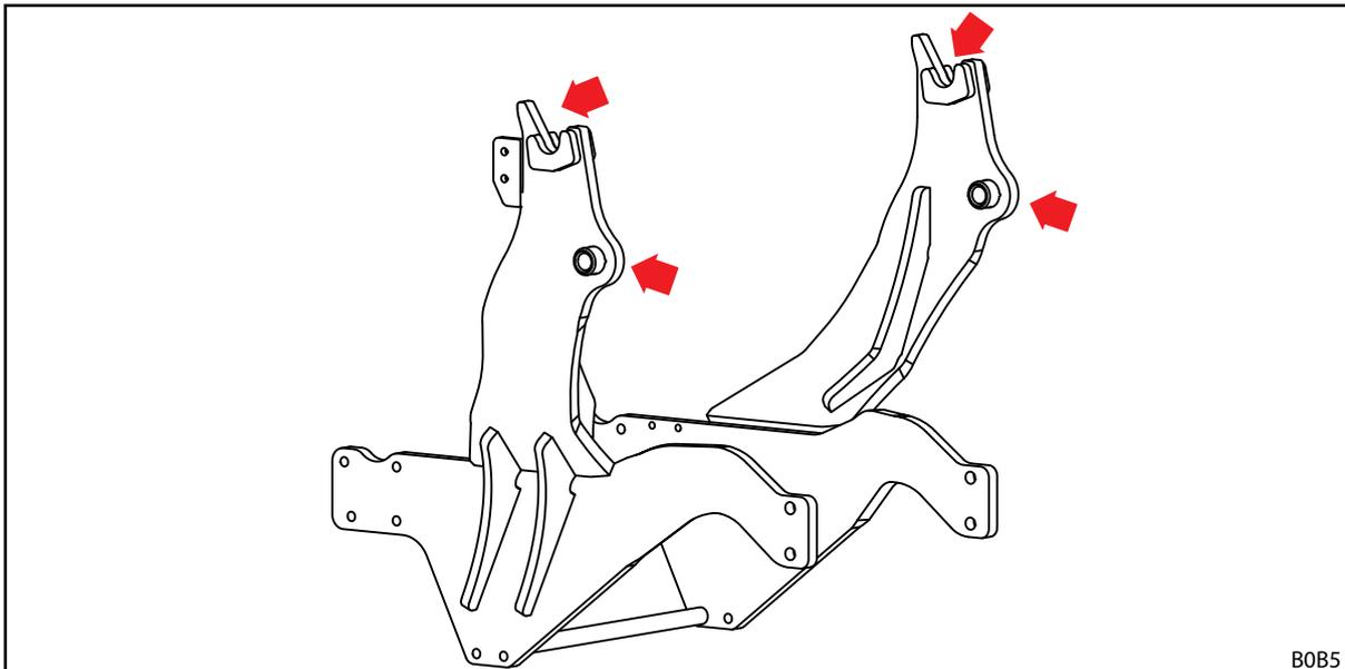
Abb. 105 Schmierstellen Frontlader-Aufnahmen
