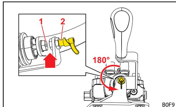
Abb. 57 Entriegelter Bedienhebel
