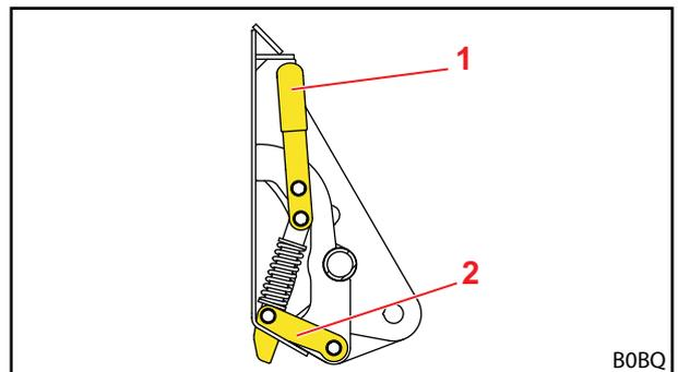
Abb. 68 Mechanische Werkzeug-Verriegelung Skid-Steer (verriegelter Zustand)
