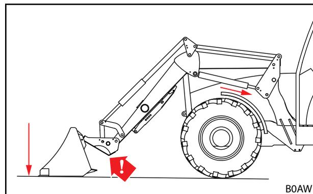
Abb. 74 Werkzeug auf den Boden drücken
