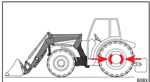
Abb. 95 Werkzeug zum Ablegen positionieren und Feststellbremse anziehen
