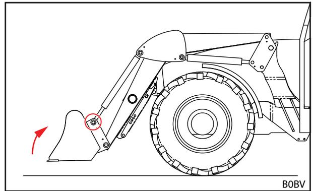
Abb. 88 Werkzeug oben mit den Hydraulik-Zylindern verbinden
