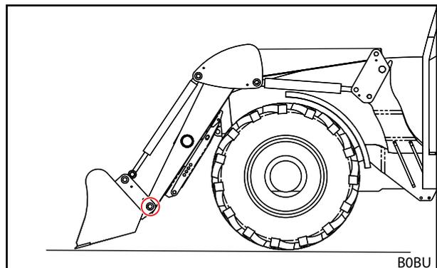
Abb. 97 Untere Bolzen herausziehen
