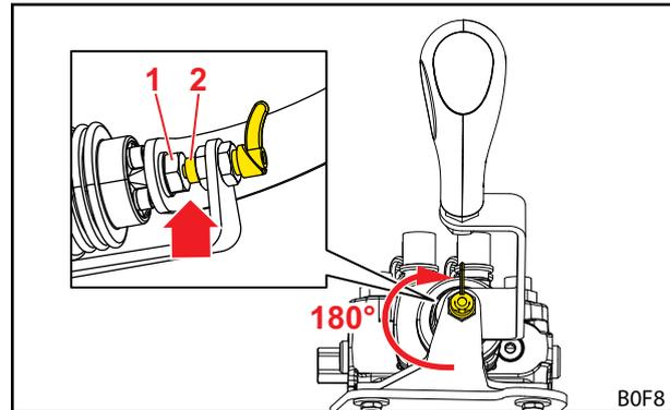
Abb. 56 Verriegelter Bedienhebel
