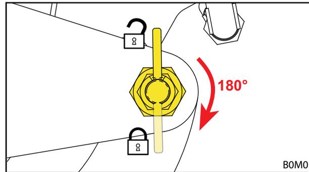
Abb. 36 Rastriegel in verriegelte Position bringen
