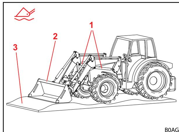
Abb. 30 Frontlader in Schwimmstellung
