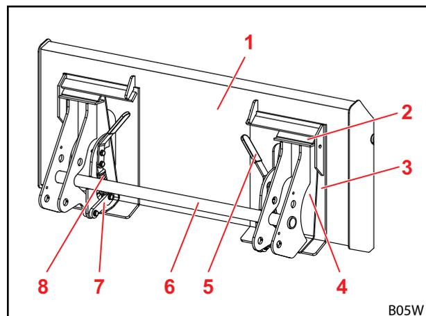
Abb. 24 Geschlossene Verriegelung
