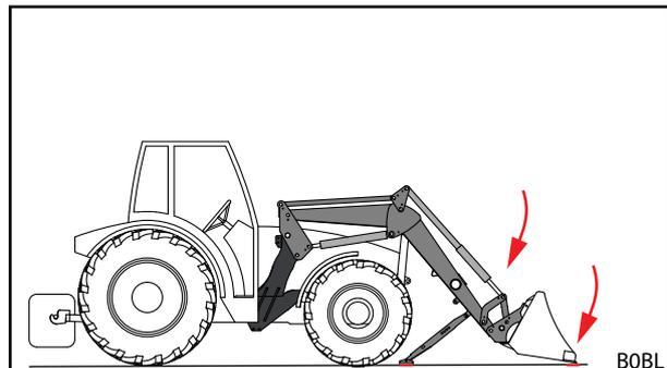
Abb. 111 Frontlader absenken und Werkzeug schütten
