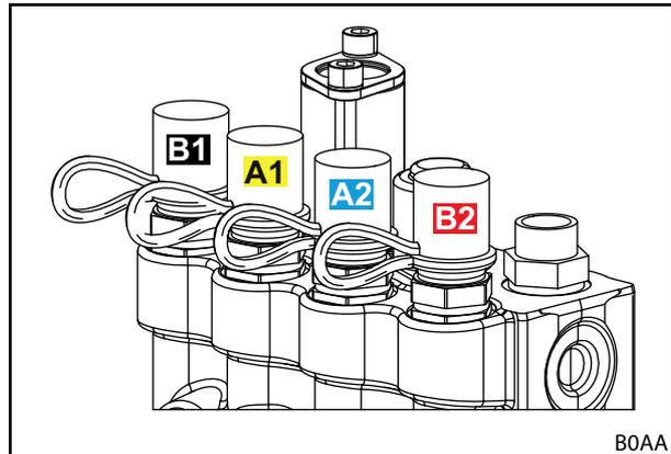
Abb. 18 Stecker der Steckkupplungen direkt am Hydraulikventil
