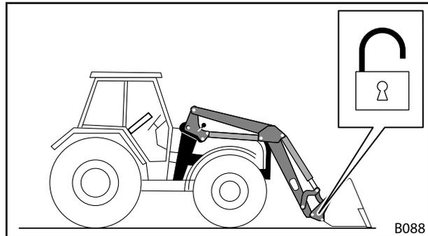
Abb. 81 Werkzeug-Verriegelung öffnen
