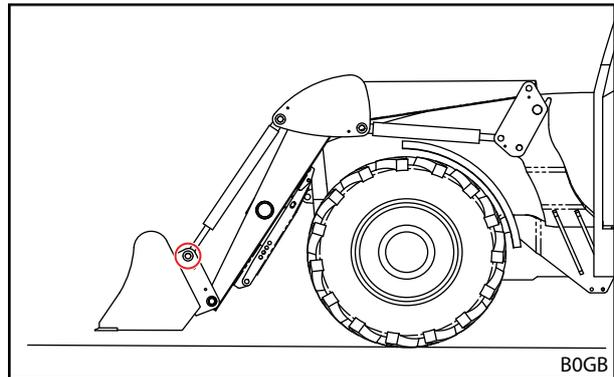
Abb. 96 Obere Bolzen herausziehen
