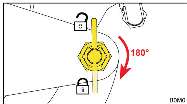
Abb. 34 Rastriegel in verriegelte Position bringen
