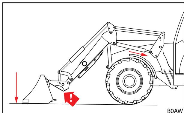
Abb. 71 Werkzeug auf den Boden drücken
