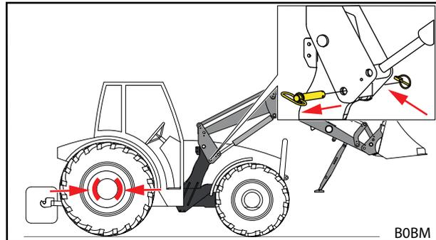
Abb. 110 Feststellbremse anziehen und Frontlader-Verriegelung lösen
