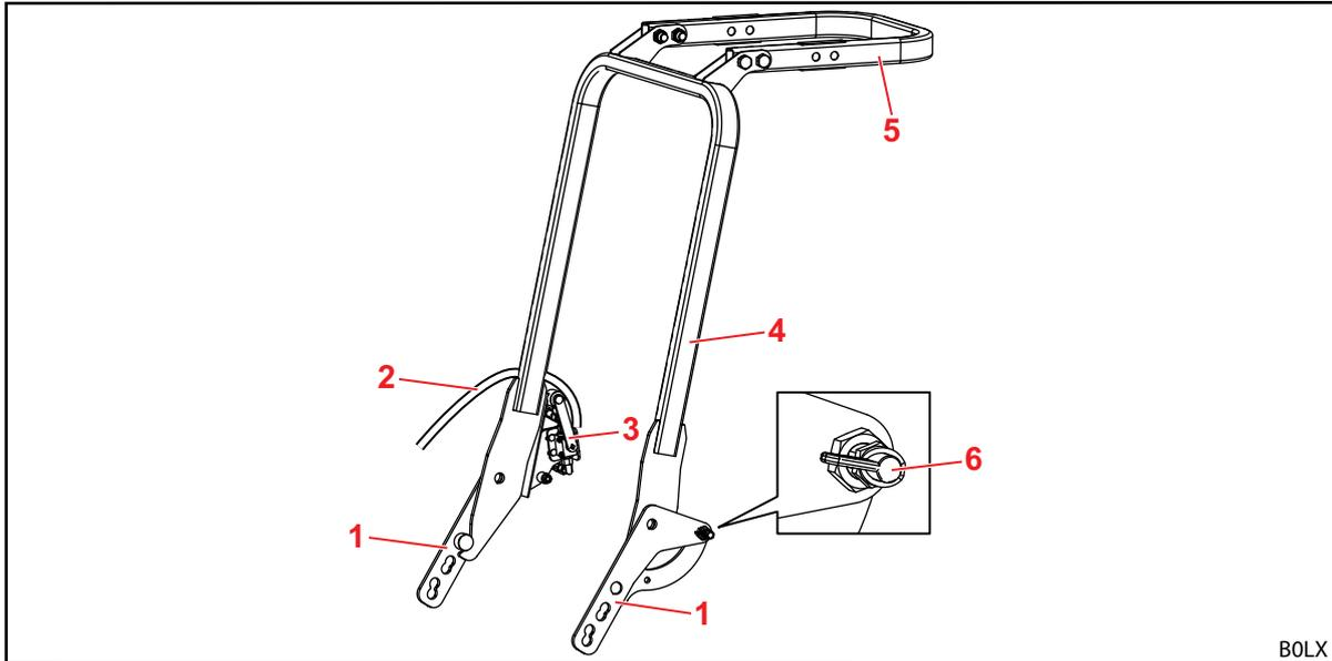
Abb. 11 Operator Protective Guard, OPG (beispielhafte Abbildung)
