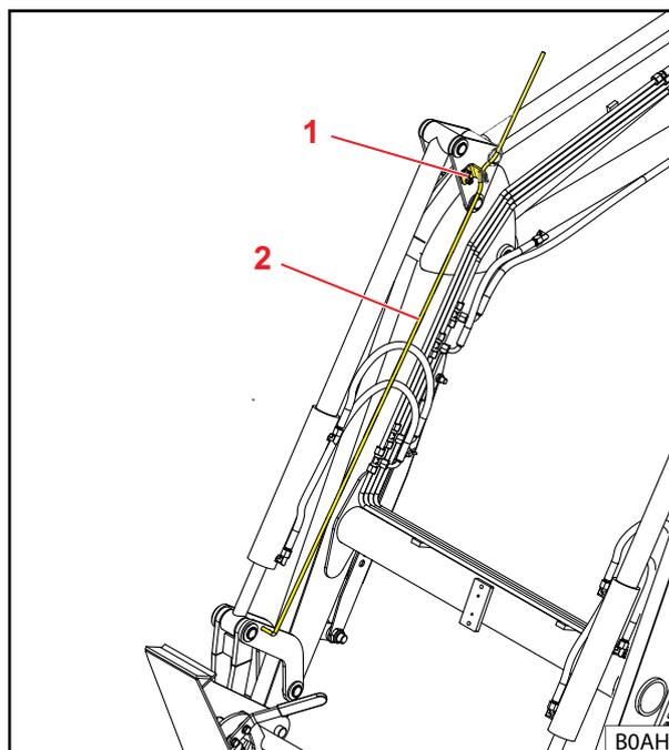
Abb. 31 Sichtanzeige für Werkzeugstellung
