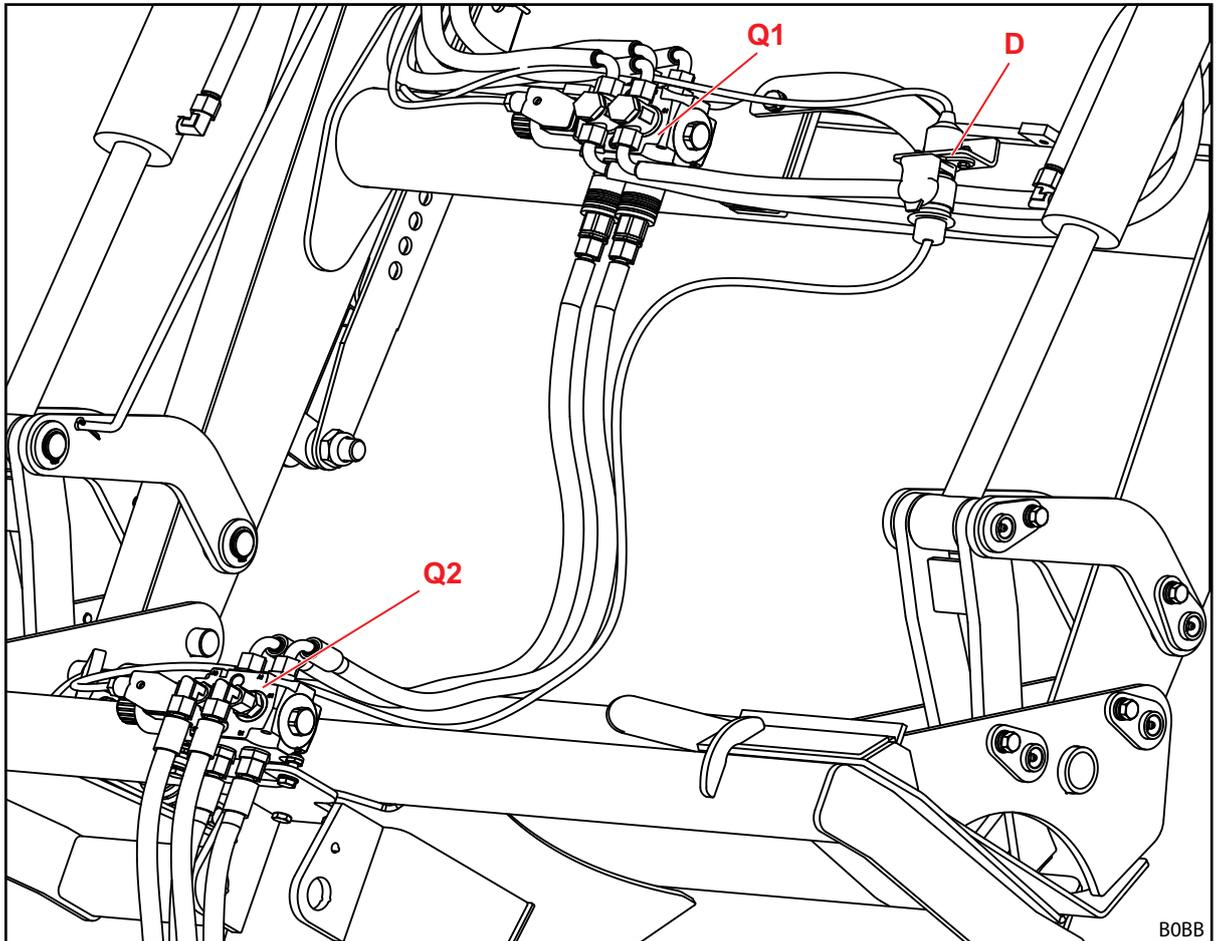
Abb. 116 Anordnung der Hydraulikventile für Zusatzfunktionen
