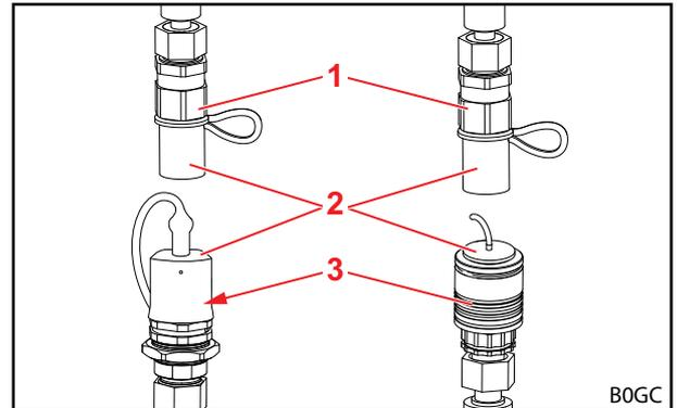
Abb. 61 Steckkupplungen (beispielhafte Abbildungen)
