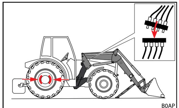
Abb. 46 Traktor abschalten und Hydraulikleitungen anschließen
