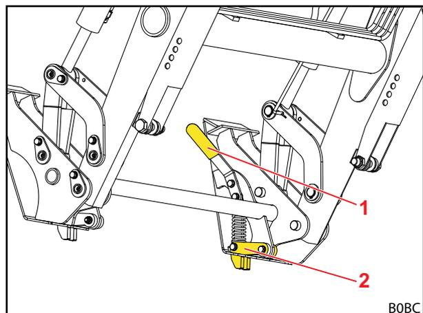
Abb. 70 Mechanische Werkzeug-Verriegelung Skid-Steer (verriegelter Zustand ohne Werkzeug)
