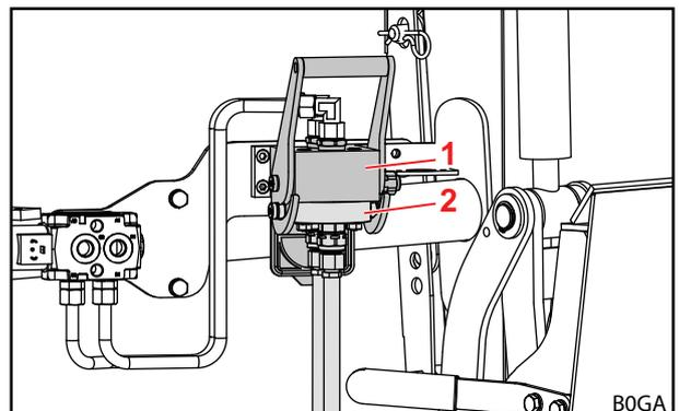
Abb. 65 Angekuppeltes Werkzeug-Fix
