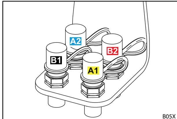
Abb. 17 Stecker der Steckkupplungen am Anbauteil
