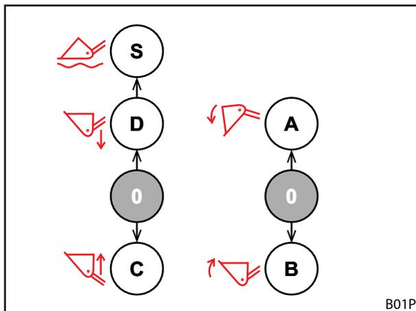
Abb. 51 Belegung bei 2 Bedienhebeln
