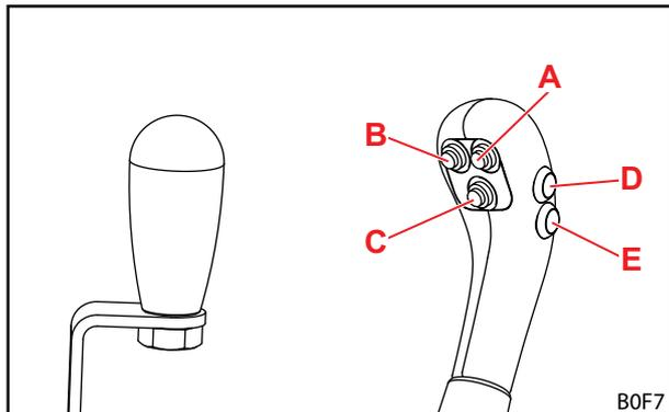
Abb. 55 Bedienhebel ohne Taster (links) und Bedienhebel mit 5 Tastern (rechts)
