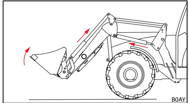
Abb. 79 Werkzeug-Verriegelung auslösen
