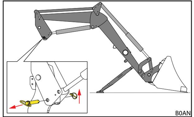
Abb. 44 Frontlader-Verriegelung öffnen
