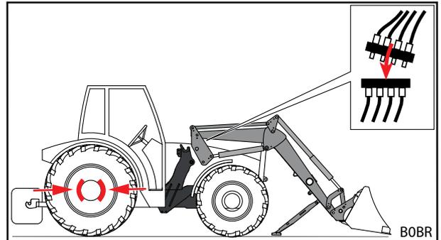
Abb. 112 Hydraulik abkoppeln
