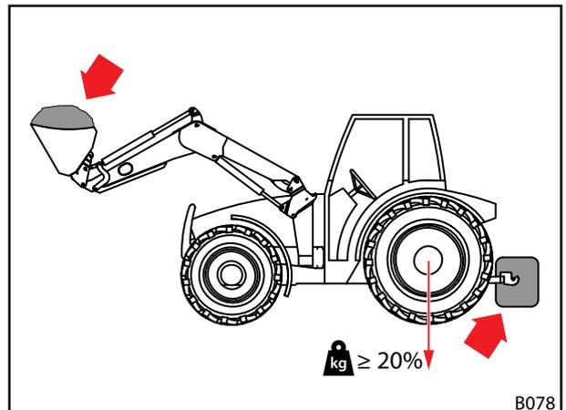
Abb. 41 Belastung bei Frontladerarbeiten
