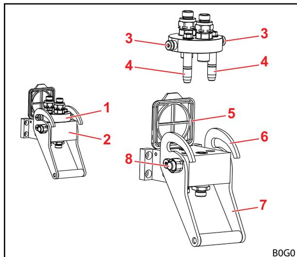
Abb. 22 Aufbau Werkzeug-Fix
