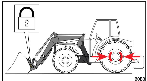
Abb. 84 Werkzeug-Verriegelung schließen
